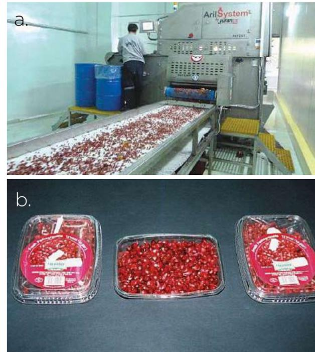
Figura 1 . Exemplo de um sistema de extração mecânica dos bagos de romã. a) Linha de extração; b) produto comercializável. Retirado do site <http://www.arisystem.com/>
